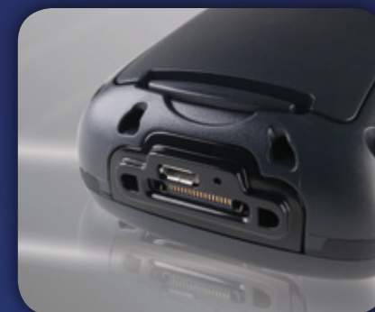
USB-on-the-Go для передачи и загрузки данных, а также автоматической настройки статуса host/client
